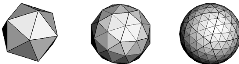
รูปที่ 4. ทรงกลมที่เกิดจากการประกอบกันของพื้นผิวเรียบ
