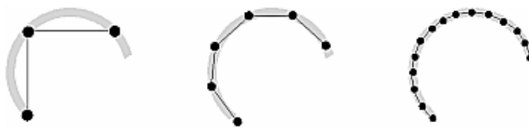
รูปที่ 3. เส้นโค้งที่เกิดจากการประกอบกันของเส้นตรง
